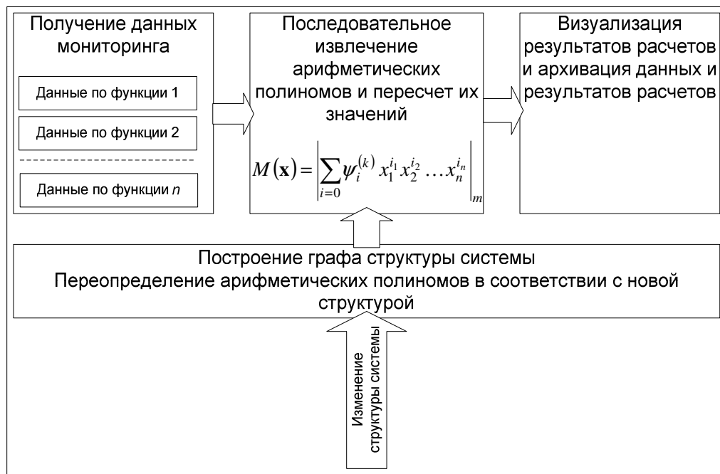
Рис. 2. Процедура мониторинга состояния технической системы с использованием логико-числовых моделей.
