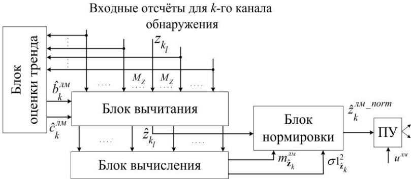
Рисунок 3 – Структурная схема предлагаемого алгоритма стабилизации ошибки первого рода на фоне нестационарного шума
