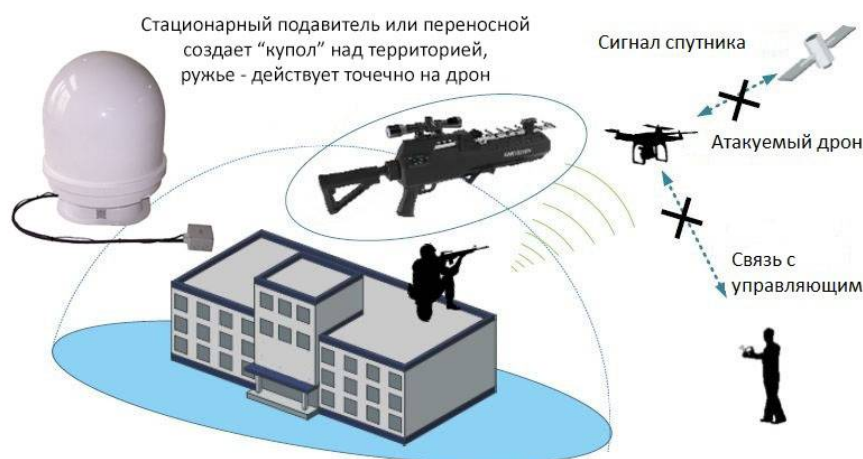
Рис. 1. Действие стационарного подавителя дронов и ружья
