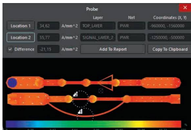
Рис. 10. Результат моделирования цепи питания с параллельными участками протекания тока
