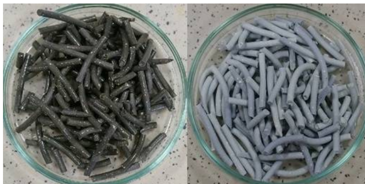
Рис. 4. Внешний вид катализатора до (слева) и после (справа) операции прокаливания
