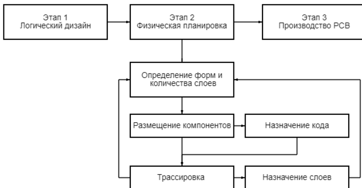
Рисунок 1 - Этапы создания печатных плат
