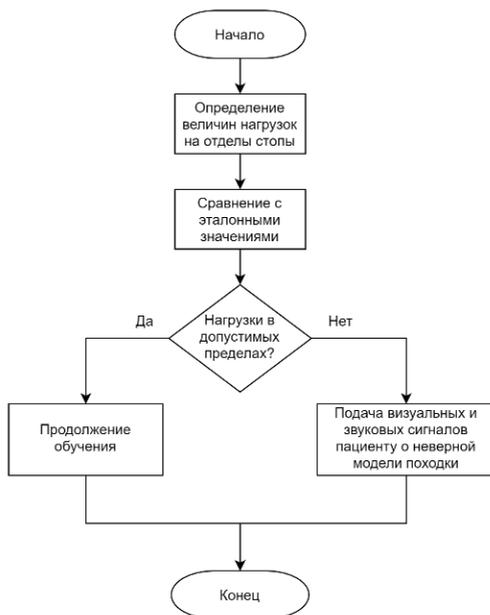
Рис.2 – Алгоритм определения правильности походки
