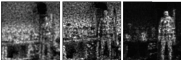
Рис. 2 – Изображение, полученное спектральным методом для системы  $32 \times 32$  электрода
