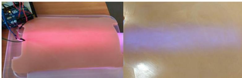
Рис. 3 – Реализация имитации окраски кожных покровов с использованием светорассеивающей трубки
