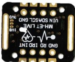
Рис. 3 – Изображение датчика пульсоксиметрии MAX30102
