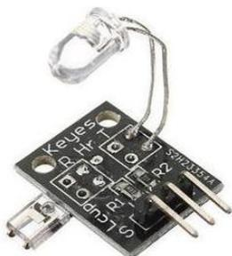
Рис. 1 – Изображение пульсоксиметрического датчика KY-039
