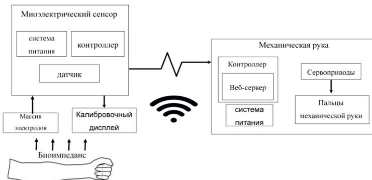
Рис. 4 – Система управления биоэлектрическим протезом.
