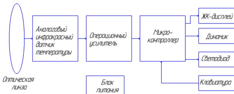
Рис. 1 – Структурная схема инфракрасного бесконтактного термометра с аналоговым инфракрасным датчиком температуры
