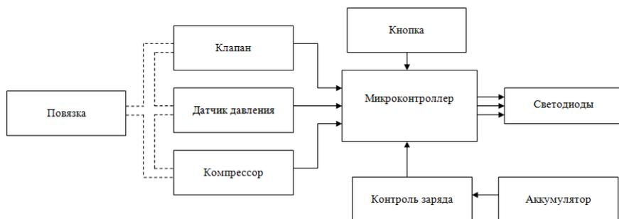
Рис. 1 – Структурная схема системы для реализации методик лечения ран отрицательным давлением
