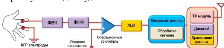
Рис. 2 – Структурная схема устройства для регистрации КГР
