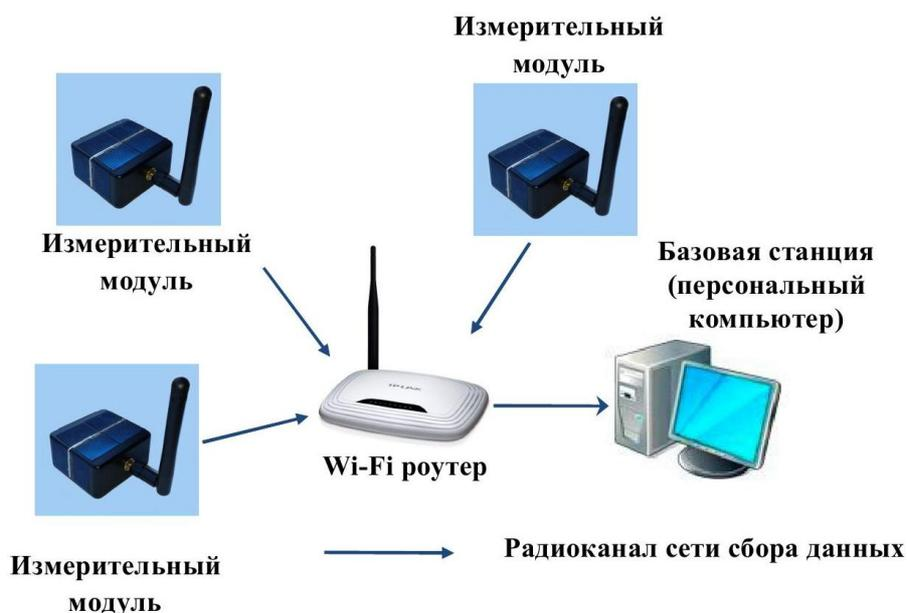
Рис. 1. Структура беспроводной сети сбора данных
