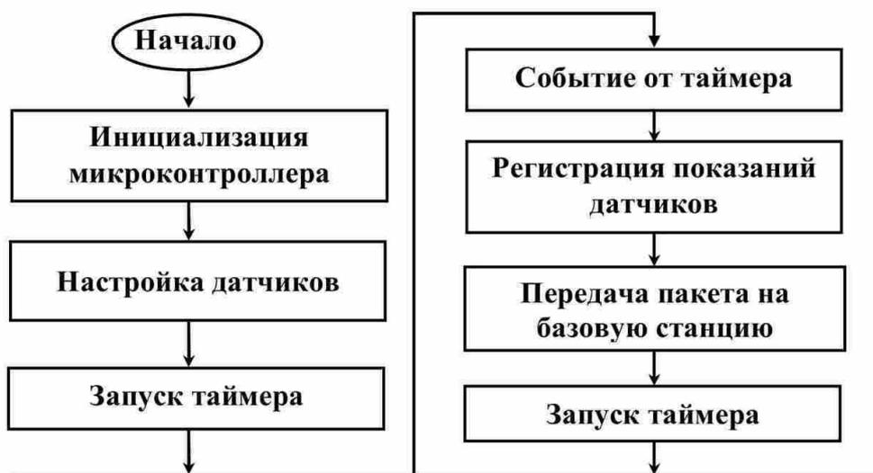
Рис. 3. Блок-схема микропрограммы измерительного модуля
