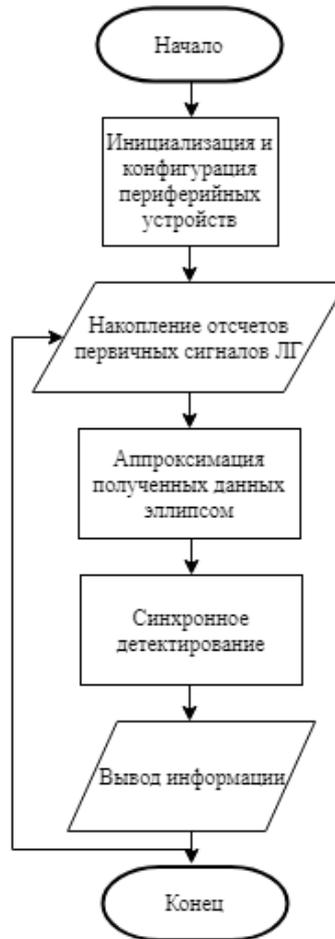
Рис. 2. Функциональная блок-схема работы системы цифровой обработки данных ЛГ
