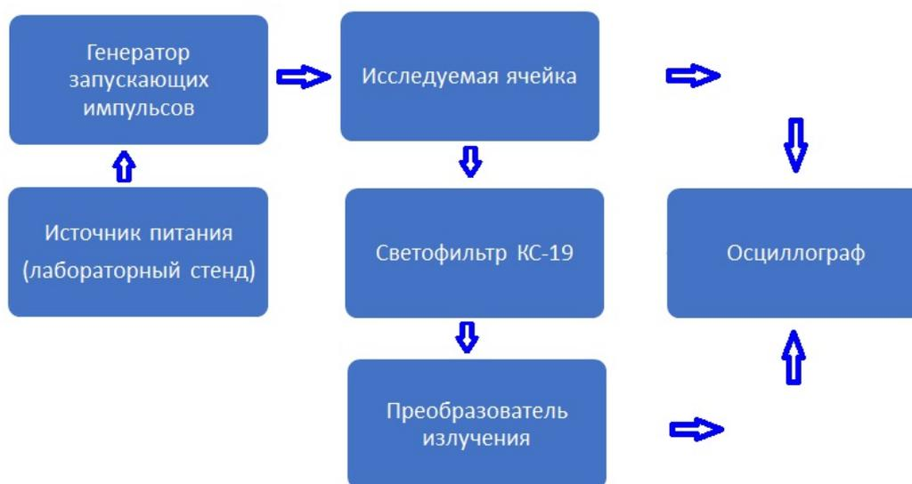
Рис. 1. Блок-схема измерительной установки
